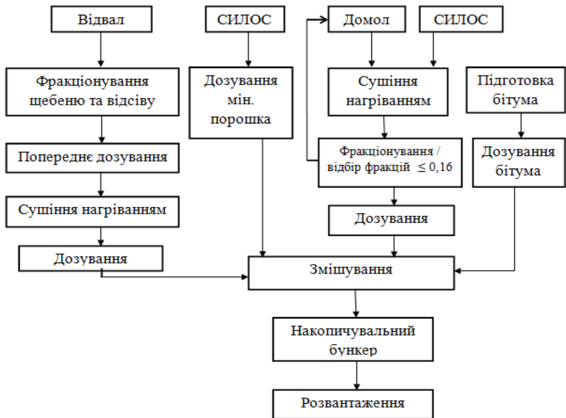
Рисунок 1.7 – Схема технологічної лінії виготовлення бітумомінеральних композицій [117]
