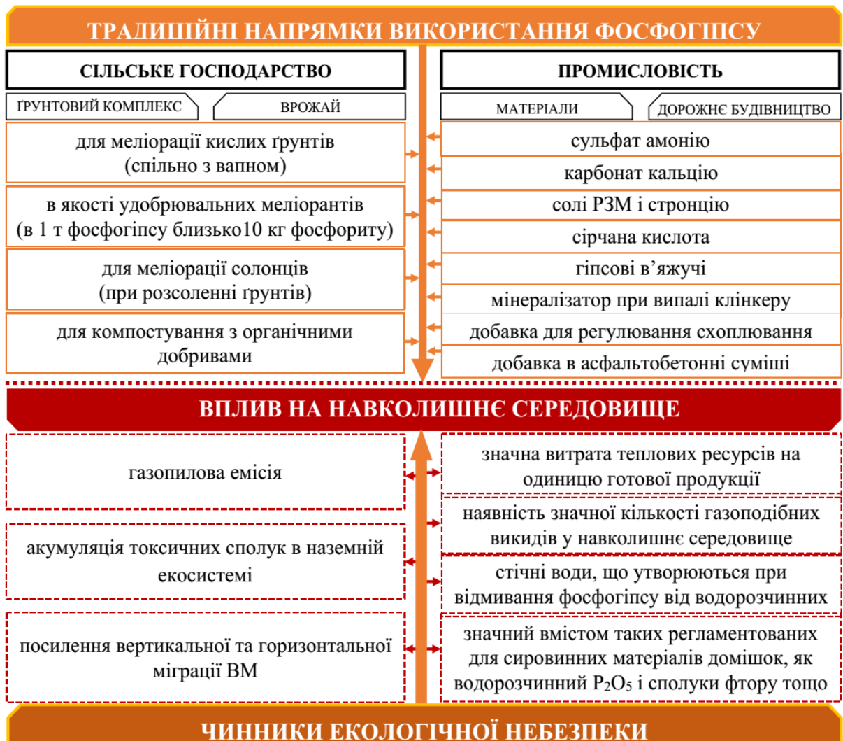
Рисунок 4.4 – Блок-схема аналізу чинників екологічної небезпеки використання фосфогіпсу в традиційних технологіях
