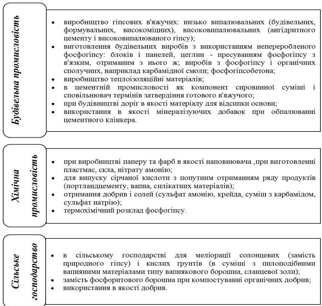
Рисунок 1.5 – Блок-схема основних технологічних рішень перероблення фосфогіпсу
