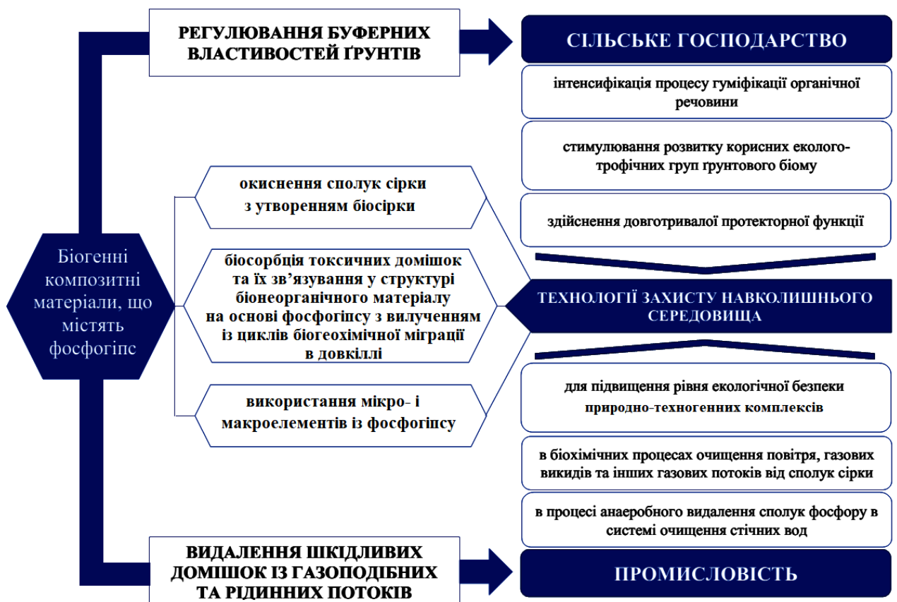
Рисунок 4.5 – Блок-схема напрямів використання фосфогіпсу як вторинного ресурсу у технологіях захисту навколишнього середовища з урахуванням еколого-синергетичних механізмів
