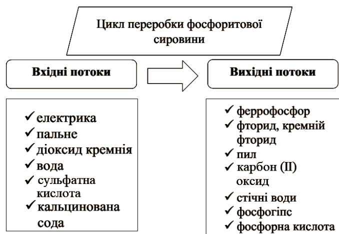
Рисунок 1.2 – Блок-схема видобутку-переробки корисних копалин на основі фосфатної породи
