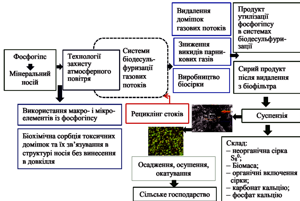
Рисунок 5.17 – Загальна блок-схема комплексного екологічно безпечного процесу утилізації фосфогіпсу з отриманням продукту переробки біосірки [234]
