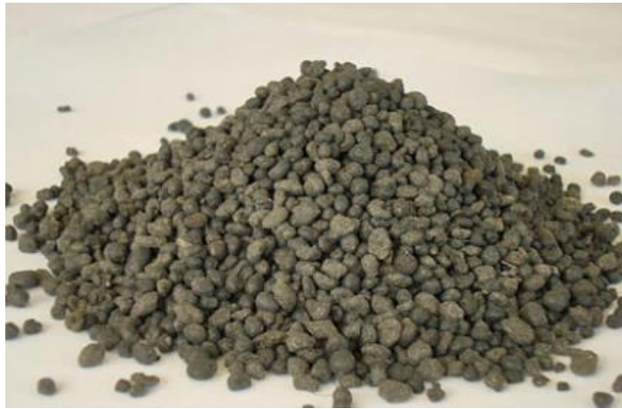
Рисунок 6.12 – Знімок біокомпозиту, що одержано після анаеробної стабілізації мулових осадів та фосфогіпсу в умовах дисиміляційної сульфатредукції
