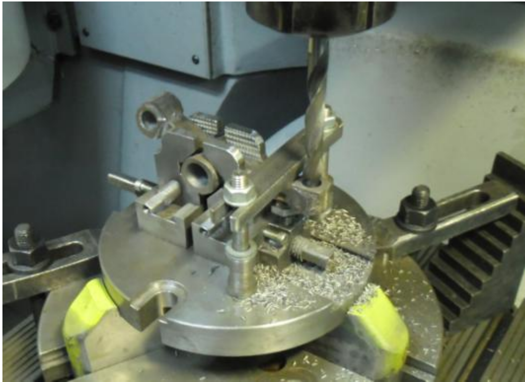
Рисунок 4.12 – Схема установки запропанованого ВП на верстаті при обробці бобишки допоміжного отвору важеля, що перпендикулярний головному
