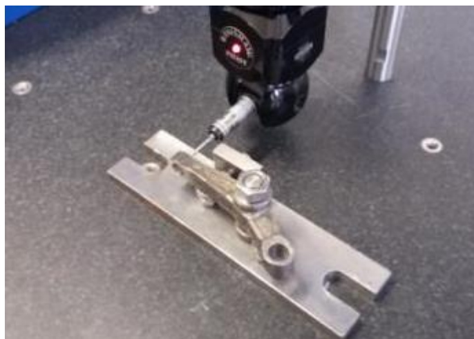
Рисунок 4.16 – Вимірювання розмірів бобишки допоміжного отвору, що перпендикулярний головному
