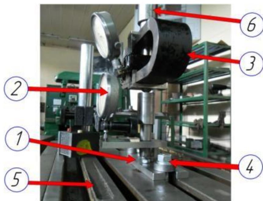
Рисунок 4.4 – Установка для вимірювання сил та переміщень у вертикальній площині для ВП: а – запропонованого; б – спеціального
