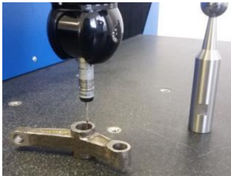
Рисунок 4.14 – Вимірювання розмірів бобишки головного отвору
