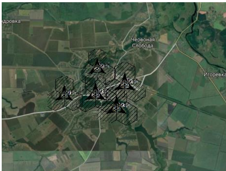
Рисунок 13 – Розташування БС на карті міста та площа стільників І остаточним етапом моделювання буде представлення на карті місцевості того як рознесений сигнал, та обмежувальна лінія.
