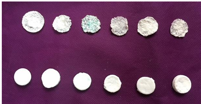
Рисунок 1.3 – Зовнішній вигляд зразків : нижній ряд – (№1- №6) ліофілізовані; верхній ряд – (№ 1а–6а) висушені при кімнатній температурі.
