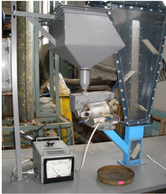
Рисунок 1.12 — Загальний вид лабораторної установки для пневмокласифікації
