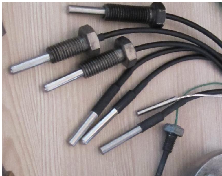
Рисунок 3.7. - Зовнішній вигляд зондів для вимірювання температур
