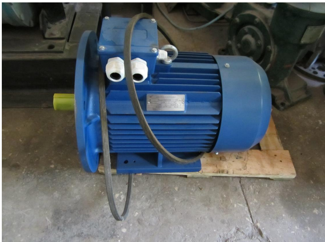
Рисунок 2.11 - Генератор асинхронного типу (асинхронний електродвигун АІР132М2)
