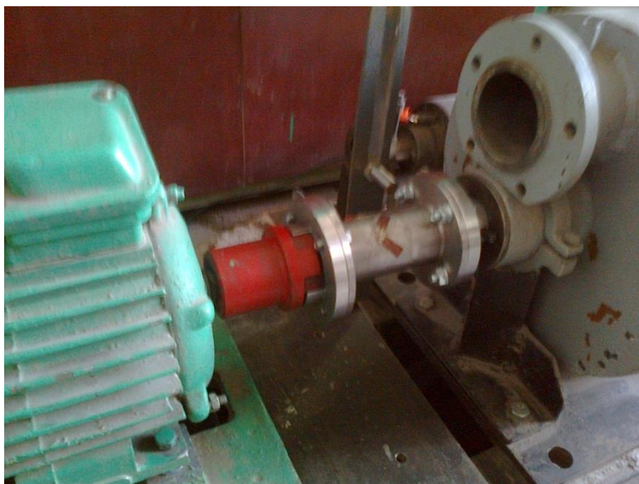
Рисунок 3.13 – Динамічні випробування приладу для вимірювання крутного моменту
