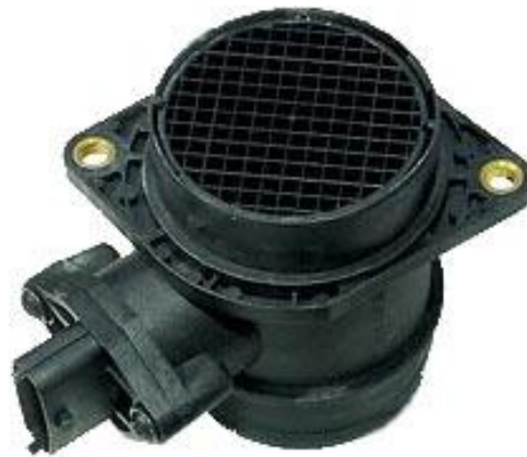
Рисунок 3.10 - Давач розходу повітря BOSCH HFM5.
