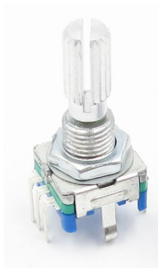
Рисунок 3.12 – Зовнішній вигляд енкодера марки EC11
