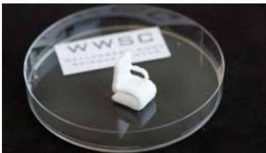
Рис. 5.3. Чернила для 3D-биопринтера из целлюлозы
