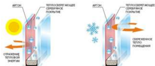
Рис. 4.1. Низкоэмиссионное стекло (Low-E — Low Emissivity)
