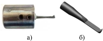
Рисунок 6 – Однозубий інструмент для обробки круглої різьби: а) інструмент, закріплений у спеціальній втулці; б) 3D-модель інструмента
