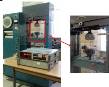
Рисунок 4– Дослідна установка для визначення пружних характеристик склопластику при розтягуванні
