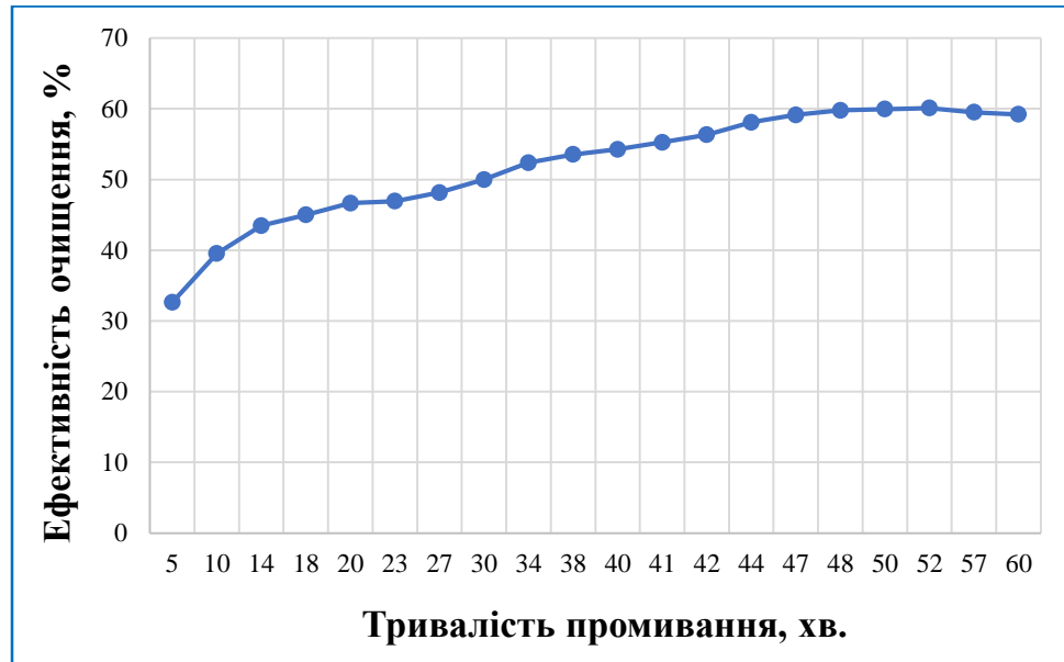
Рисунок 4.6 – Залежність ефективності очищення фільтрувального паперу перкарбонатом натрію від тривалості промивання
