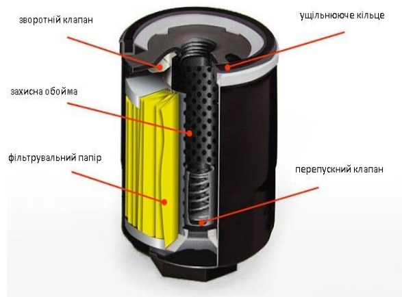
Рисунок 3.9 – Конструкція автомобільного масляного фільтра
