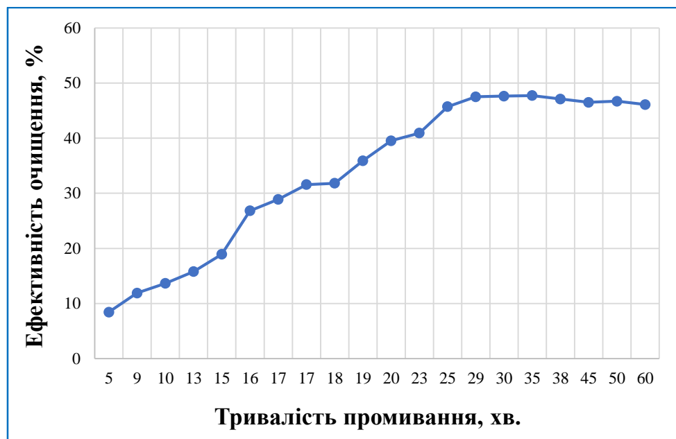
Рисунок 4.4 – Залежність ефективності очищення фільтрувального паперу кальцинованою содою та перекисом водню від тривалості промивання
