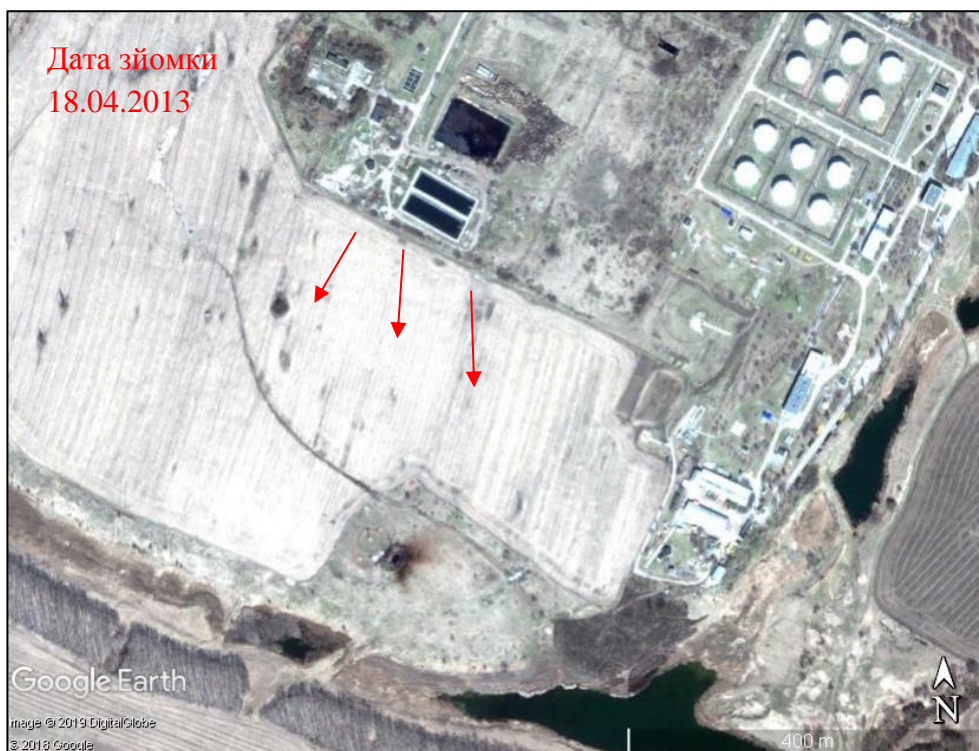
Рисунок 4.10 – Відкриті споруди зберігання СПВ на Глинсько-Розбишівському родовищі (стрілками показані напрямки руху забруднених підземних вод)
