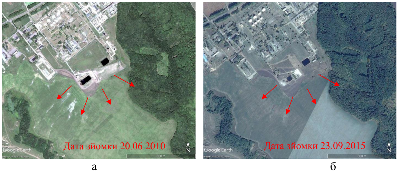
Рисунок 4.8 – Очисні споруди на ЦППН Качанівського родовища (стрілками показано напрямки руху забруднених підземних вод)
