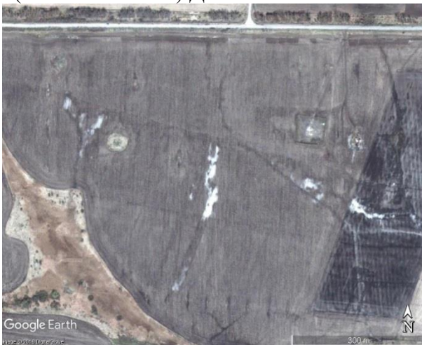
Рисунок 3.3 – Ділянки засолених ґрунтів унаслідок витоків СПВ із водоводів на родовищах Східного НГ басейну
