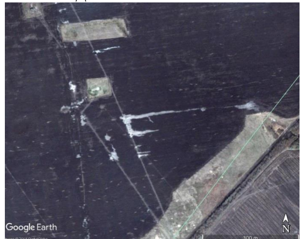
Рисунок 3.3 – Ділянки засолених ґрунтів унаслідок витоків СПВ із водоводів на родовищах Східного НГ басейну
