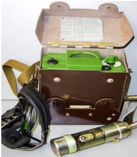
Рисунок 1.4 – Прилад радіаційної розвідки ДП-5В
