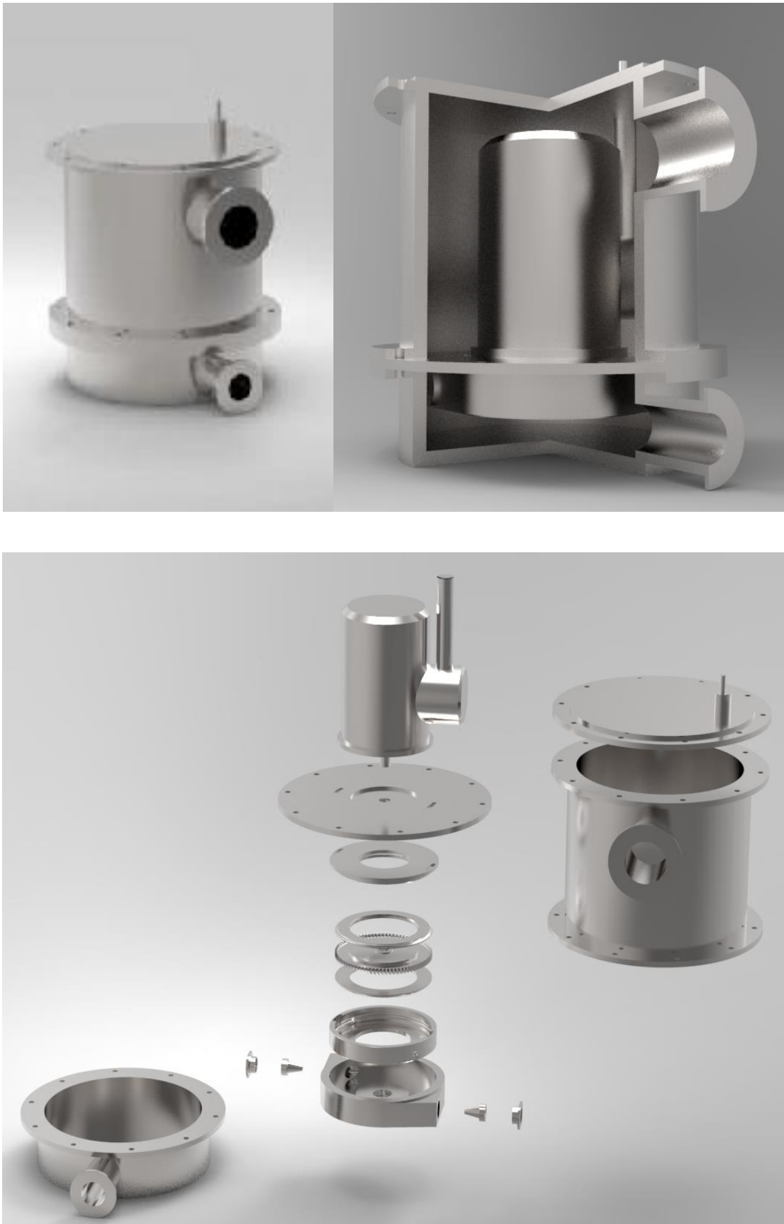
Рисунок 2.32 - – Конструкція турбогенератора на базі вихрової розширювальної турбомашини.
