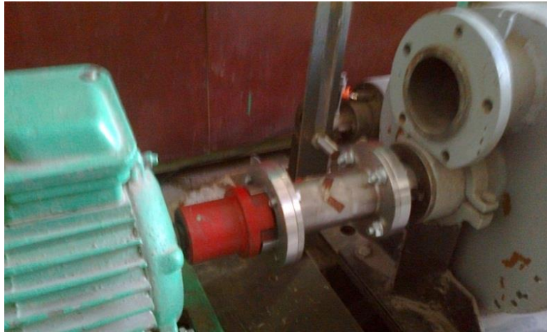
Рисунок. 3.24- Динамічні випробування приладу для вимірювання крутного моменту
