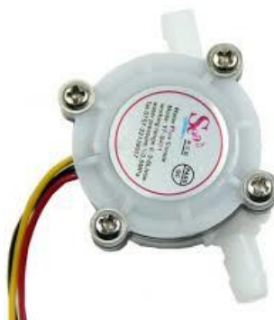
Рисунок 3.2 Датчик витрат YF-S401
