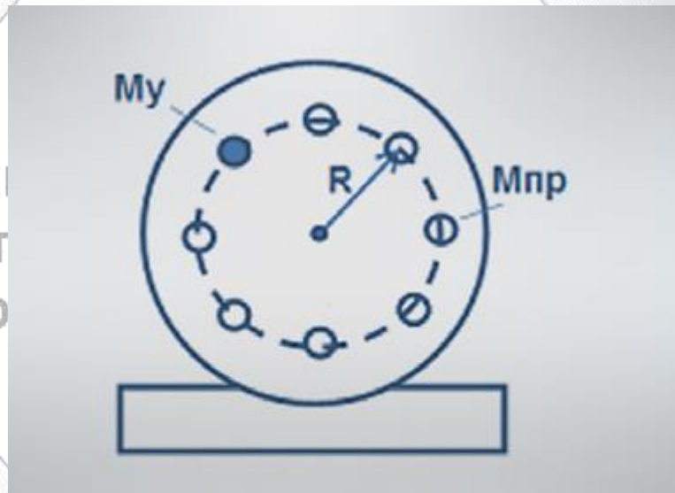
Рисунок 3.5 – Схема встановлення вантажу при балансуванні методом обігу пробним вантажем
