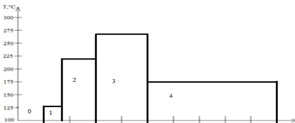
Рисунок 2.6 - Розподіл температур у випадку поломки 1-ої секції
