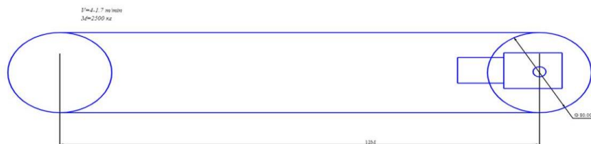
Рисунок 3.9 - Місце встановлення мотор-редуктору
