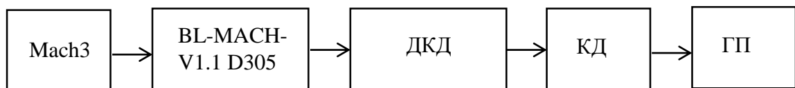
Рисунок 2.1. Спрощена схема верстата з ЧПУ
