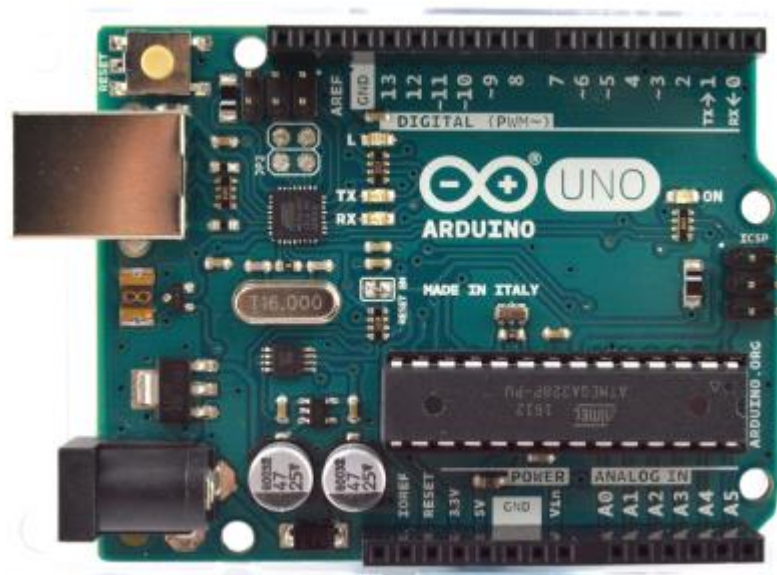
Рисунок 2.26. Фізичний вигляд Arduino UNO
