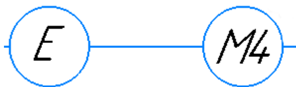
Рисунок 2.29. Позначення контуру керування робочим органом на ФСА: М4 – шпиндель з диммером, Е – мікропроцесорний пристрій Arduino UNO.
