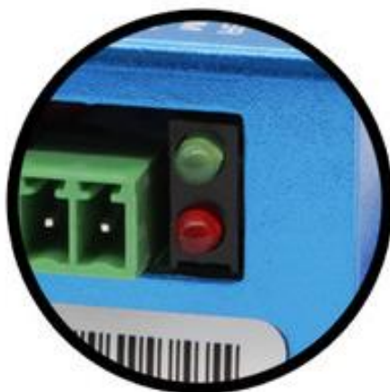
Рисунок 2.23. Індикатори на драйвері крокового двигуна
