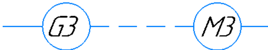
Рисунок 2.27. Позначення осей переміщення на ФСА: М3 – кроковий двигун, G3 – механічно з'єднаний енкодер.
