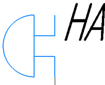
Рисунок 2.31. Позначення кнопки аварійної зупинки на ФСА.
