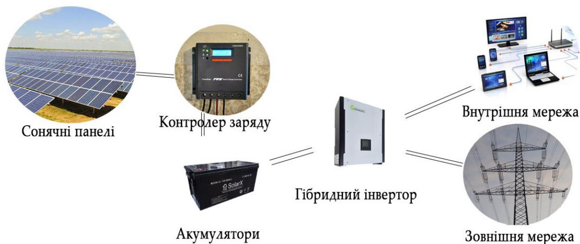
Рисунок 2.2 . Принцип роботи гібридної сонячної електростанції
