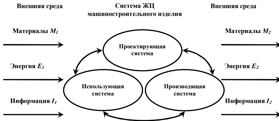
Рисунок 1 - Открытая система ЖЦ машиностроительного изделия
