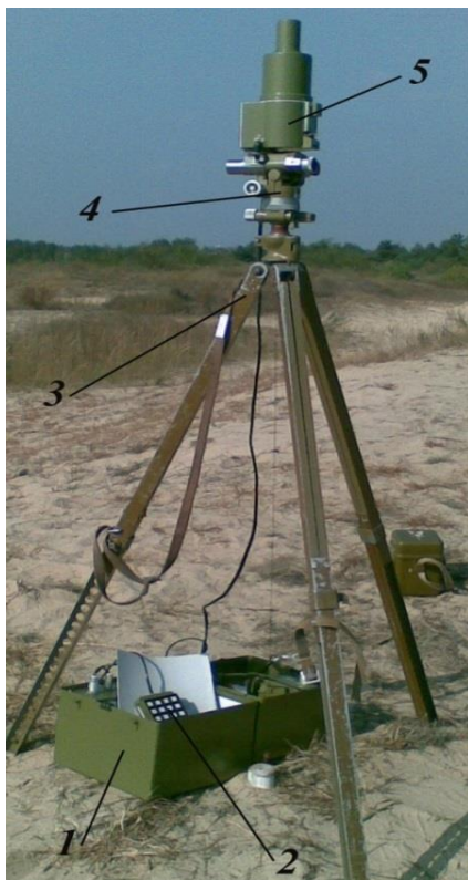
Рисунок 2.38 – Монтаж комплекту 1Г51У на тринозі з бусоллю ПАБ-2А:
