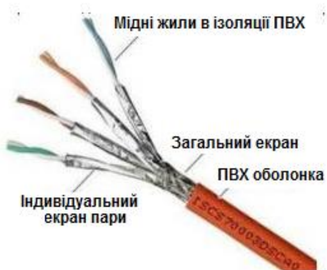
Рис.2.6 - Екранована «вита пара» [1]
