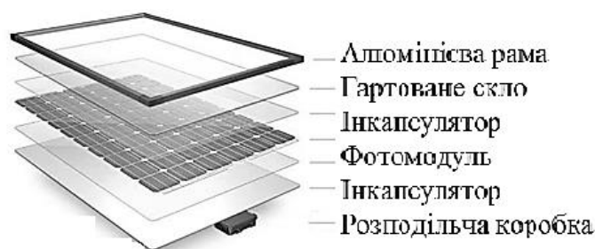
Рисунок 1.2 – Будова сонячної панелі. Адаптовано із роботи [4]
