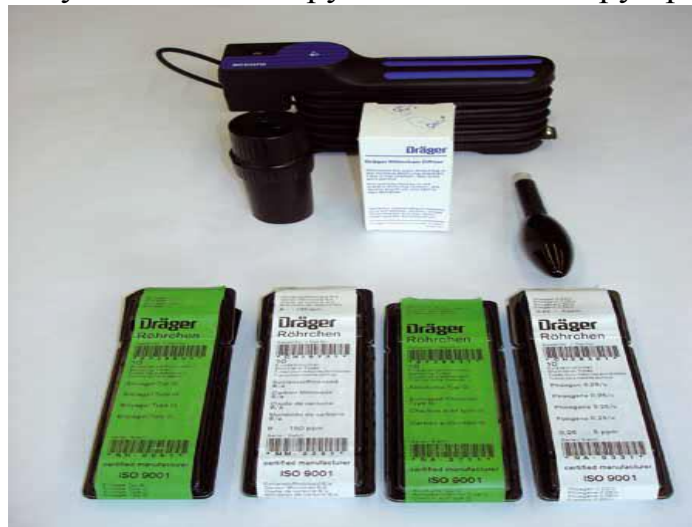
Рисунок. Е.5 – Ручний насос та індикаторні трубки
