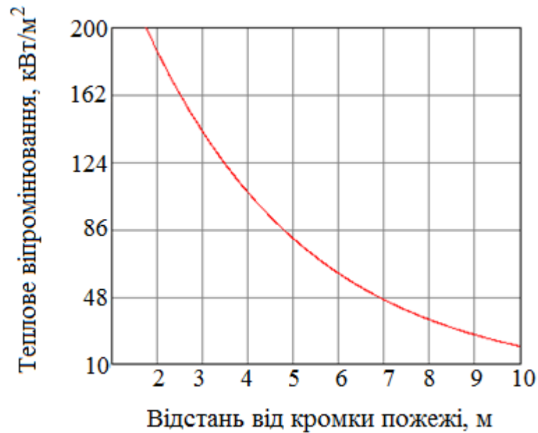
Рисунок 2.4 – Розрахунок залежності щільності променистого теплового потоку від фронту лісової пожежі
