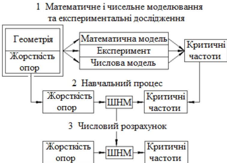
Рисунок 3.3 – Розрахункова схема задачі оцінювання критичних частот ротора
