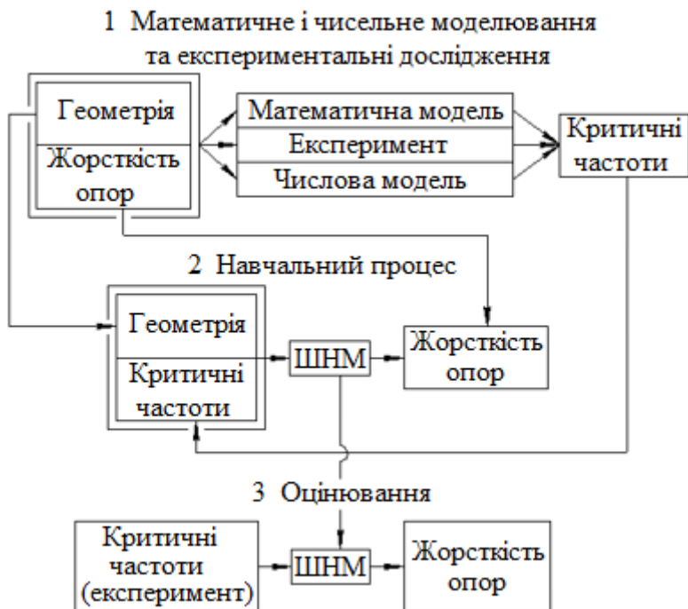
Рисунок 3.4 – Оцінювання жорсткості опор ротора
