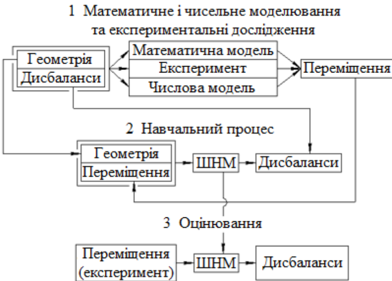
Рисунок 3.6 – Розрахункова схема проведення процедури балансування ротора
