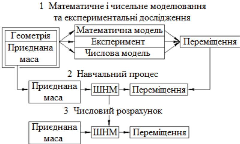
Рисунок 3.7 – Розрахункова схема дослідження динаміки гідромеханічної системи
