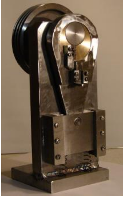
Рисунок 8 – Діюча модель безмуфтового преса, виготовленого у металі
