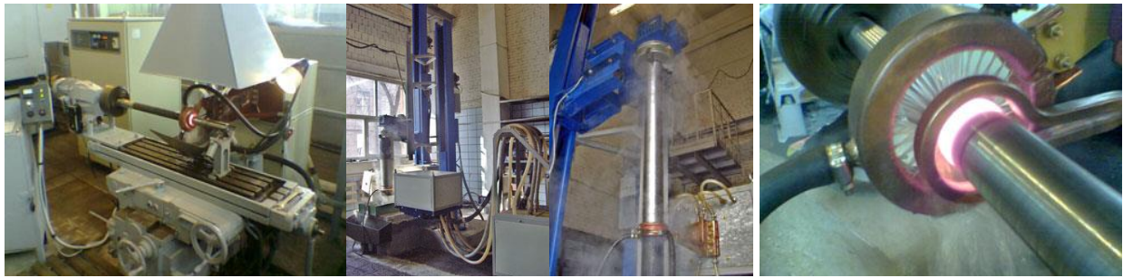
Рисунок 8 – Поверхнєве гартування валів струмами високої частоти
