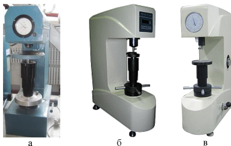
Рисунок 8 – Зовнішній вигляд твердомірів за Роквеллом: ТК-2 (а), ТН 550 (б) і цифрового твердоміра ТН 500 (в)
