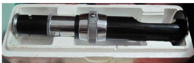
Рисунок 5 – Зовнішній вигляд лупи Брінелля МПБ-2
