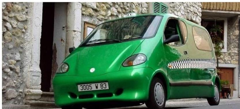
Рисунок 6.41 – Автомобиль на сжатом воздухе Tata One CAT (Tata, 2017)
