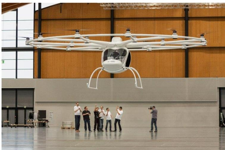
*Рисунок 6.31* – Электрический мультикоптер Volocopter VC 200 (Лучший, 2013).
