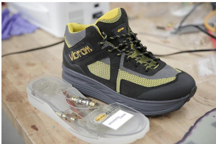
*Рисунок 5.18* – Кроссовки – генератор энергии (Lavars, 2016).
