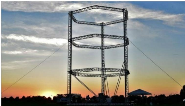
Рисунок 4.12 – 3D-принтер компании WASP (высота 12 м, диаметр – 6 м)
