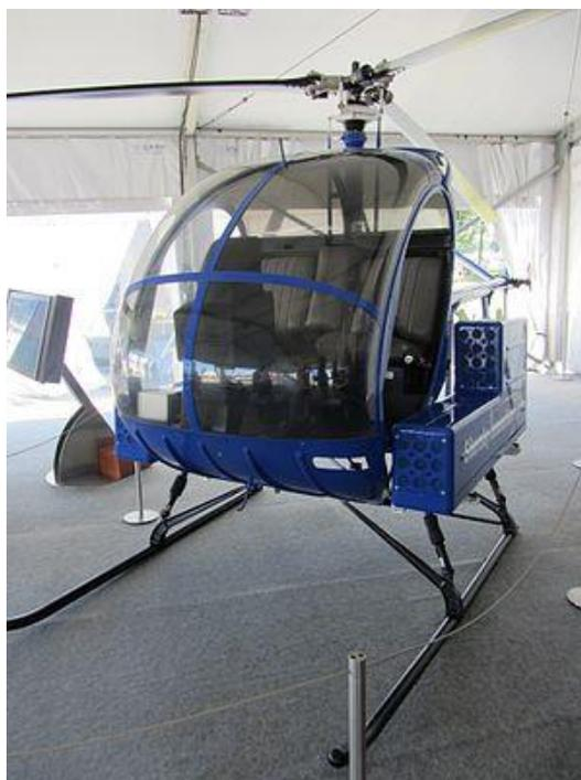
*Рисунок 6.29* – Электровертолѐт Sikorsky Firefly (Sikorsky, 2016).
