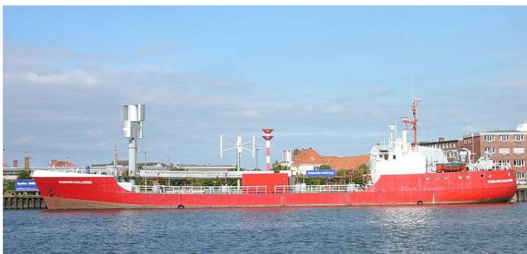
Рисунок 6.40 – Немецкий танкер Hydrogen Challenger (водород производится на борту за счёт энергии ветра) (Водородный транспорт, 2017)
