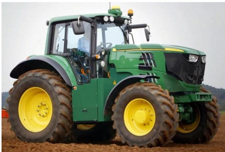
Рисунок 6.16 – Электрический трактор фирмы John Deere (Костин, 2016).
