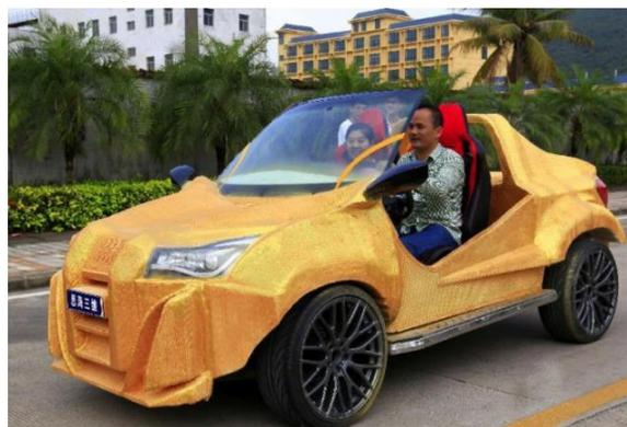
Рисунок 4.3 – Распечатанный на принтере электромобиль китайской компании Sanya Sihai (Китайцы, 2015)
