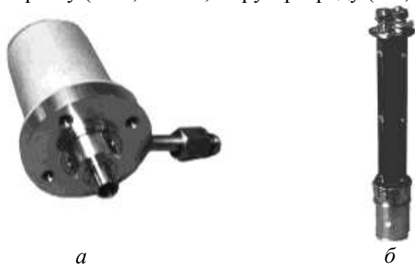
Рисунок 3 – Зовнішній вигляд джерела іонів (а) та мас-аналізатора (б)
