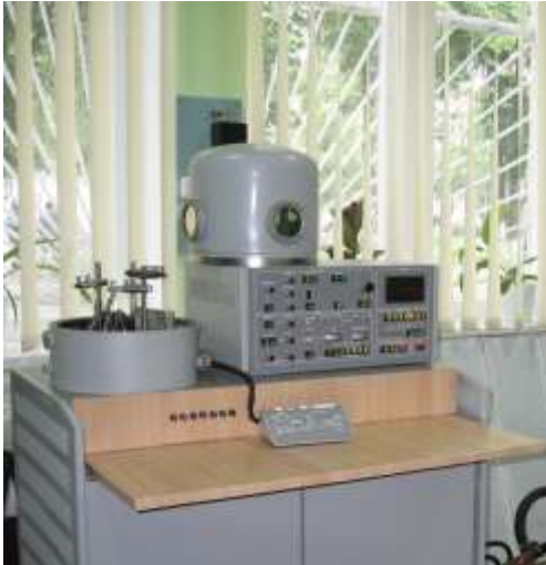
Рисунок 2 - Зовнішній вигляд вакуумної установки для конденсації плівкових зразків ВУП-5М
