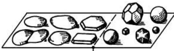
Рисунок 2 – Схема утворення плівок за різними механізмами конденсації
