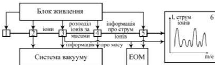
Рисунок 1 - Блок-схема мас-спектрометра: 1 – досліджуваний зразок; 2 – джерело іонів (електронів); 3 – мас-аналізатор; 4 – приймач іонів; 5 – підсилювач; 6 – пристрій реєстрації
