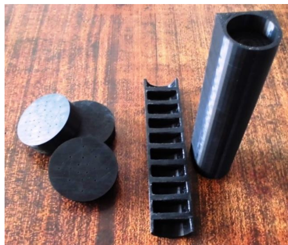
Рисунок 3.21 – Прототипи капілярних насосних систем, виготовлені за допомогою 3D-друку
