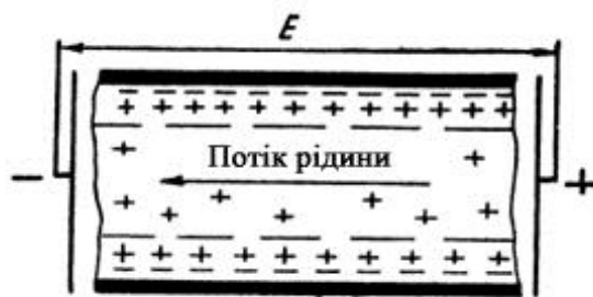
Рисунок 3.12 – Утворення подвійного електричного шару і рух рідини під впливом електричного поля
