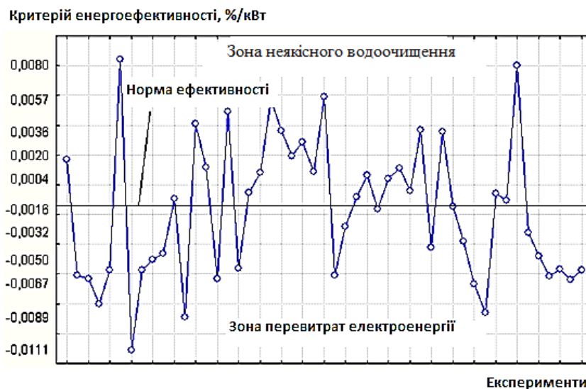
Рисунок 7 – Експериментально отримані у ВМЕВ значення ЕЕЕ промислового водоочищення
