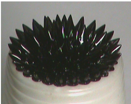
Рисунок 4.28 – Магнітна рідина під дією магнітного поля
