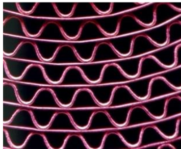
Рисунок Е.3.3 – Структура укладання первинного носія із сітки на основі ніхрому.
