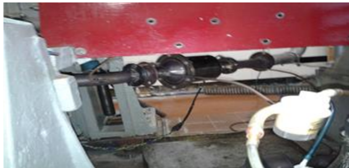
Рисунок Е.2.8 – Зовнішній вид блоку експериментального каталітичного нейтралізатора відпрацьованих газів у зборі на двигуні
