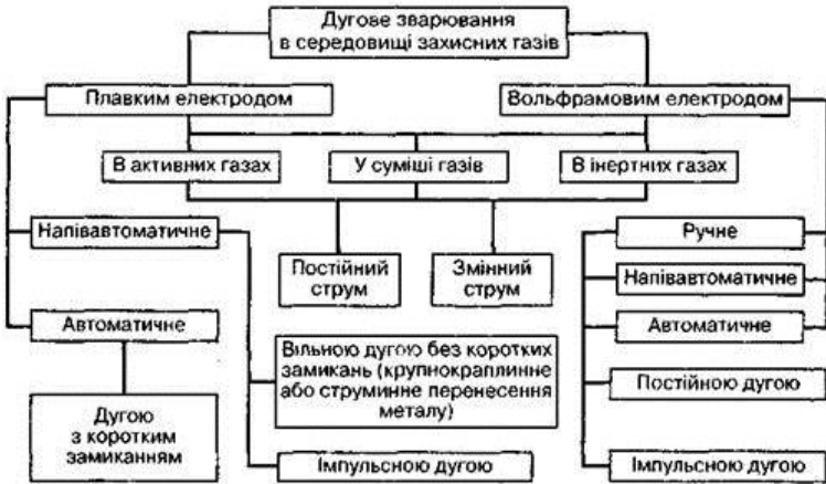
Рисунок 6.8 – Класифікація способів зварювання в захисних газах
