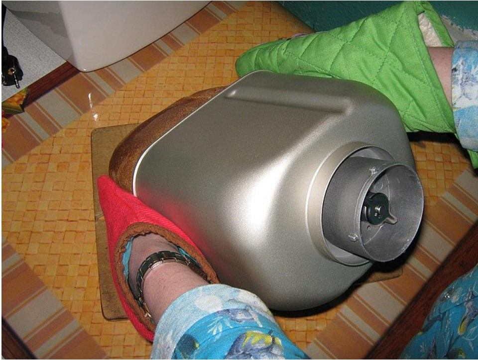
Рис. 1.2 – На дні форми знаходиться муфта, в центрі якої – вал
