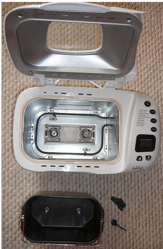
Рис. 1.4 – Хлебопічка з двома крутящими механізмами
