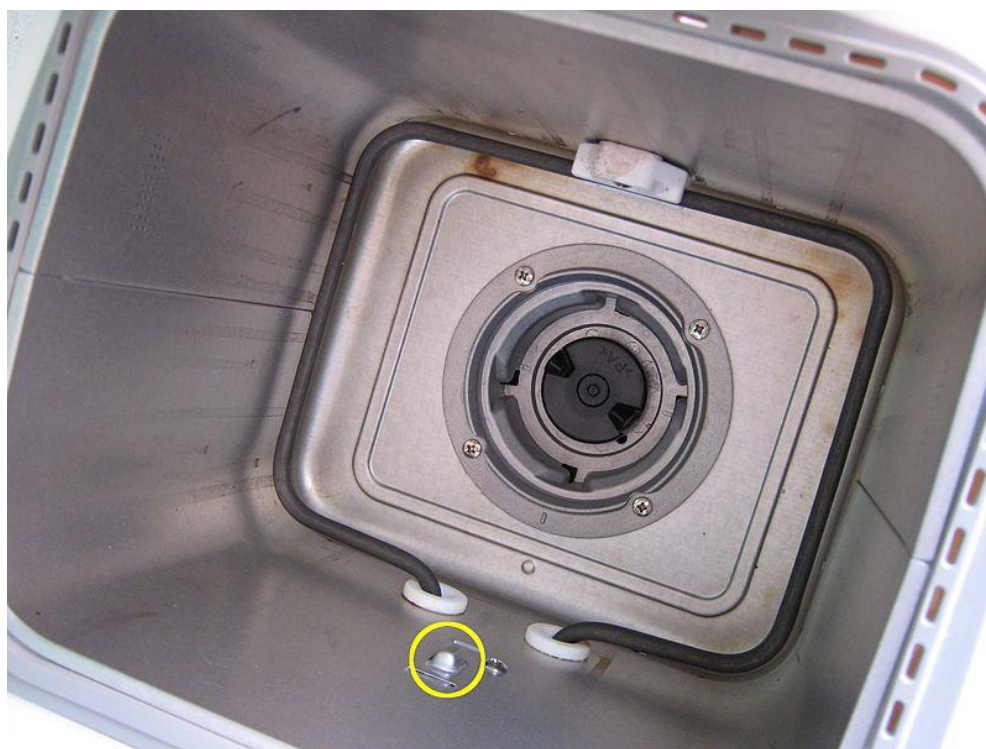
Рис. 1.1 – Розташування деталей в пекарної камері: по периметру нижньої частини - нагрівальний елемент - ТЕН, на дні - муфта, в центрі якої - крутний механізм (деталь у вигляді гуртка чорного кольору)
