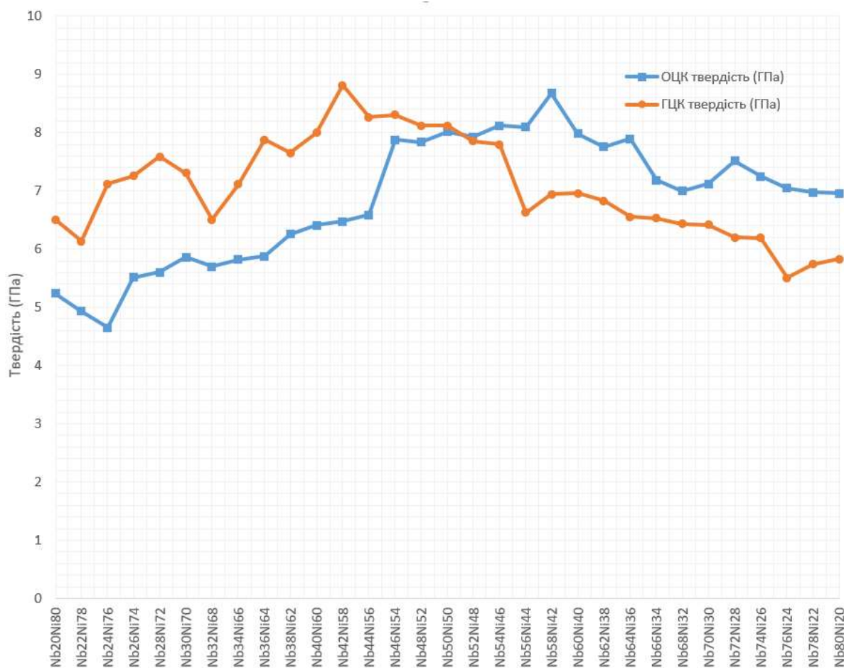
Рис 3.2 – Порівняння значень твердості для ОЦК та ГЦК структур Ni-Nb
