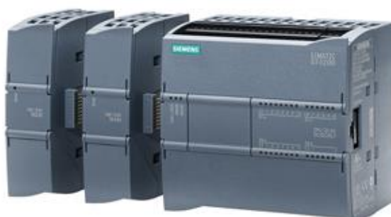
Рисунок.4.0. PLC SIMATIC S7-1200
