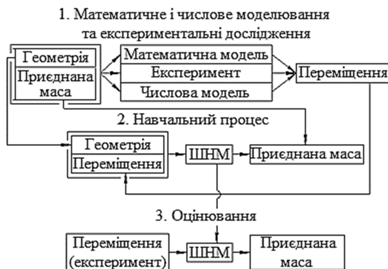
Рисунок Г.2 – Розрахункові схеми дослідження динаміки гідромеханічної системи (а) і оцінювання приєднаної маси (б) із застосуванням ШНМ
