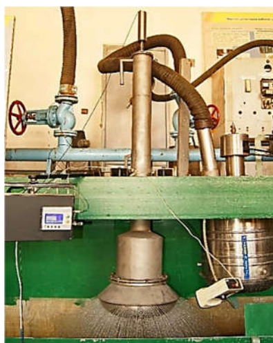
Рисунок П.1 – Схема обертового віброгранулятора
