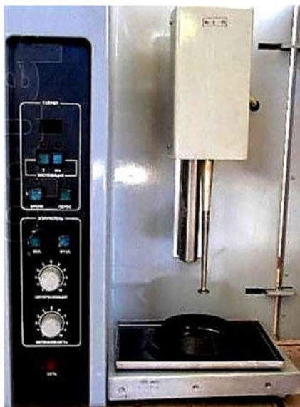
Рисунок К.3 – Загальний вигляд ультразвукового диспергатора для дослідження капілярного підйому рідини за умов вібраційного впливу
