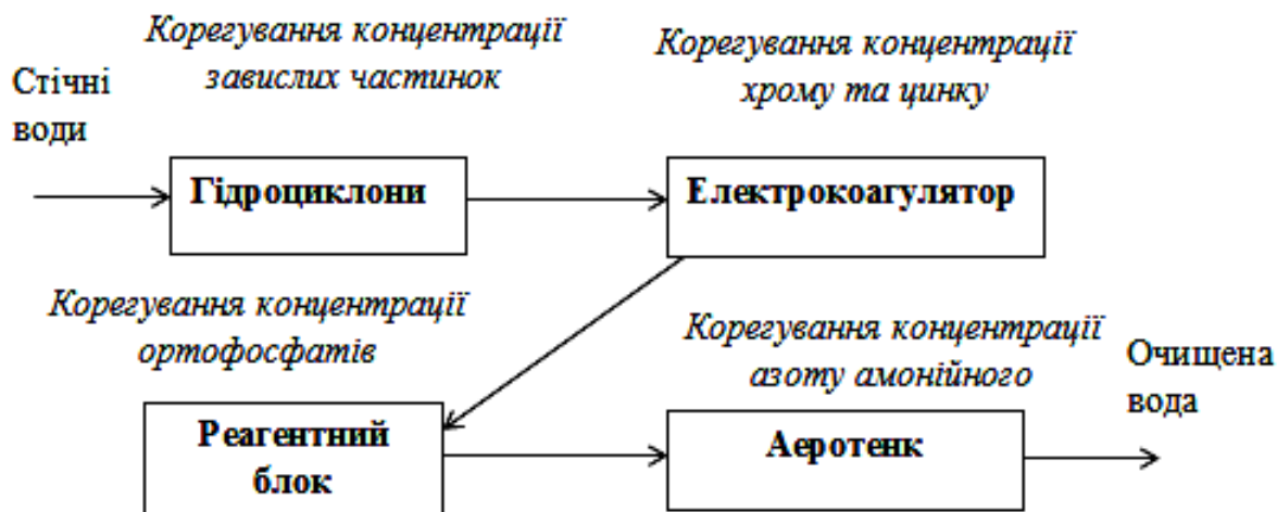
Рисунок 2.6 – Варіант загальної структурної схеми використання комбінованих способів очищення стічних вод промислових об'єктів
