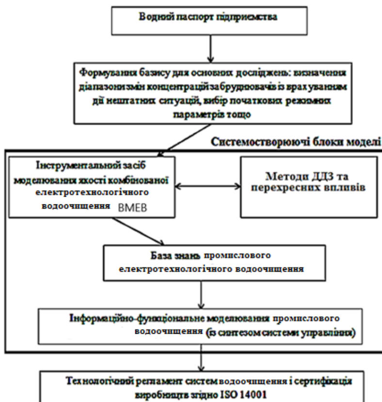
Рисунок 4.32 – Логічна модель результатів досліджень промислового водоочислення на основі отримання та опрацювання та ефективного використання еколого-енергетичної інформації із врахуванням дії надзвичайних ситуацій
