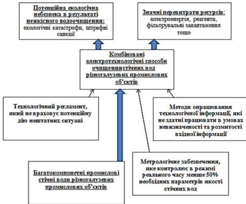
Рисунок 2.30 – Проблемна область забезпечення ефективності комбінованого очищення стічних вод промислових об'єктів
