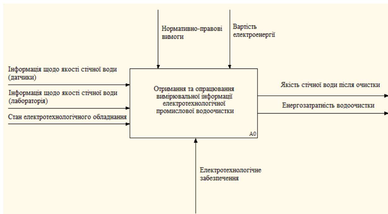
Рисунок 2.2 – Контекстна діаграма отримання та опрацювання техніко-економічної інформації промислового водоочищення
