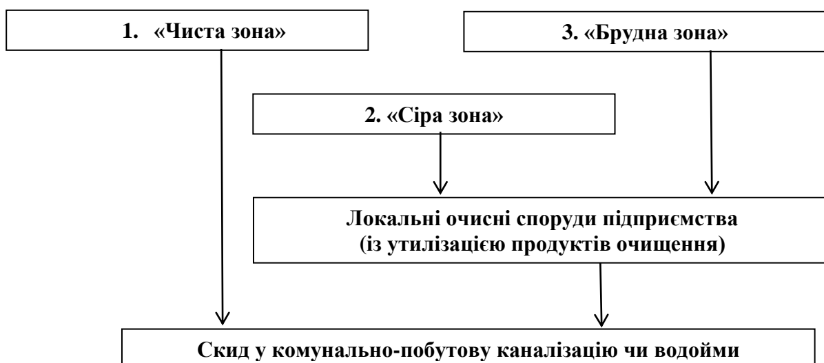
Рисунок 2.40 – Екологічно безпечна схема водовідведення небезпечних виробничих об'єктів із врахуванням наявності «сірої зони»
