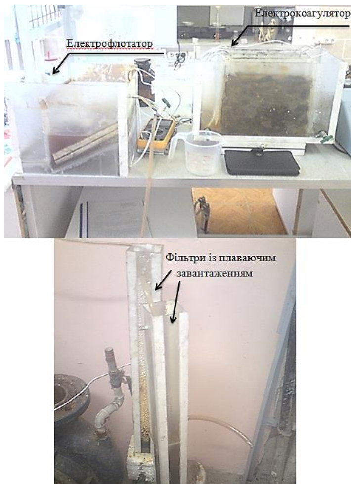
Рисунок 3.3 – Зовнішній вигляд електрообладнання очищення стічних вод м'ясопереробного підприємства (досліди проводились безпосередньо на підприємстві)
