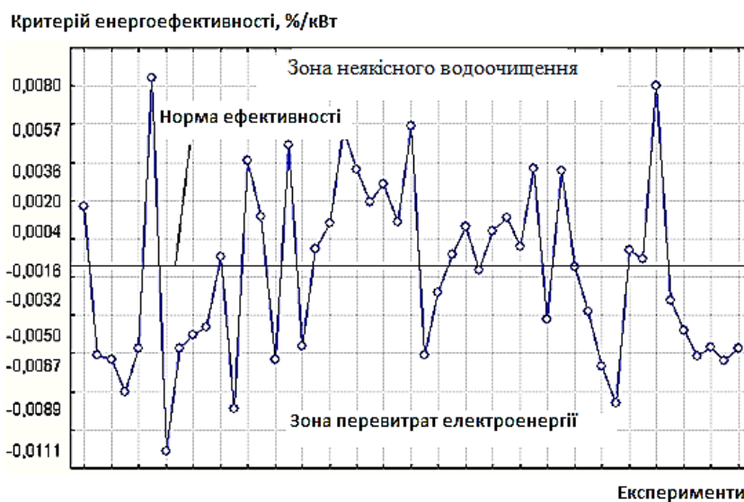
Рисунок 3.27 – Експериментально отримані значення ЕЕК комбінованих систем водоочищення (ВМЕВ)
