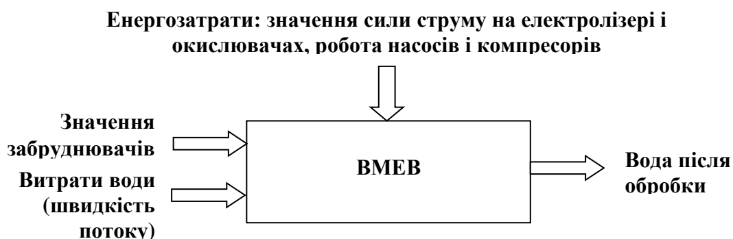
Рисисунок 3.21 – Структура проведення досліджень із використанням ВМЕВ
