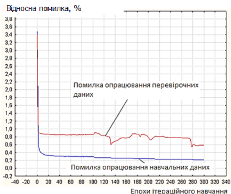
Рисунок 3.29 – Якість синтезу моделі процесів комбінованого водоочищення (багатошарового персептрона)
