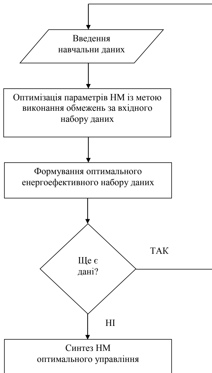
Рисунок 4.19 – Блок-схема алгоритму синтезу НМ оптимального управління комбінованим водоочищенням
