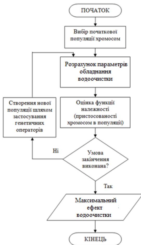
Рисунок 2.9 – Блок-схема генетичного алгоритму процедури вибору параметрів елементів комбінованих систем водоочищення
