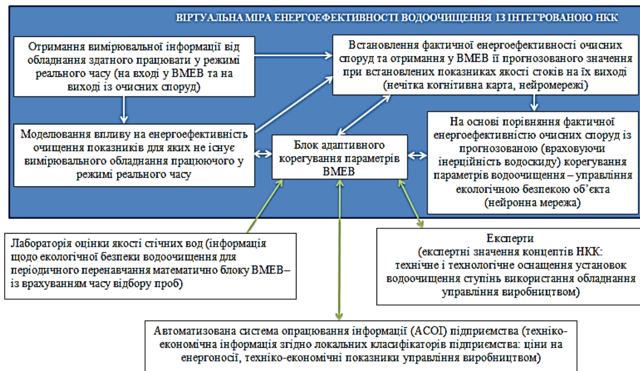
Рисунок 4.29 – Структурна модель отримання, опрацювання використання техніко-економічної інформації з вимірюванням параметрів еколого-енергетичної ефективності в промислових умовах на основі ВМЕВ
