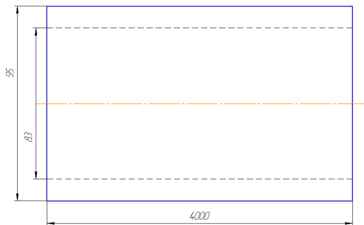
Рисунок 5.2 – Ескіз заготовки з холоднодеформованого прокату
