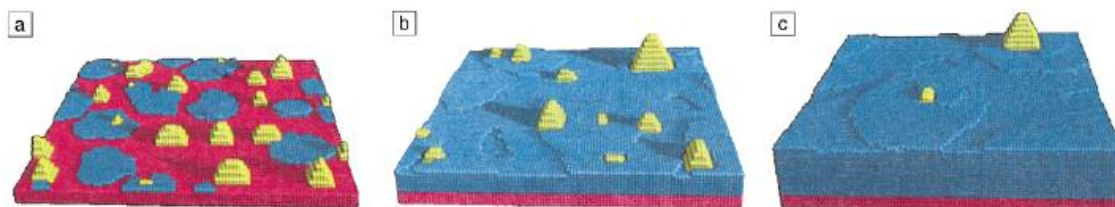
Рисунок 4. Модель осадження плівки алюмінію при температурі 300 К
