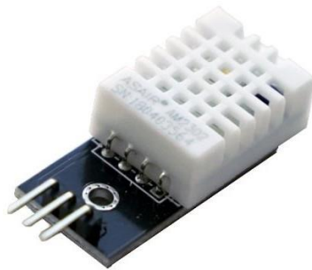
Рисунок 4.3 – Зовнішній вигляд датчика DHT22 [41]
