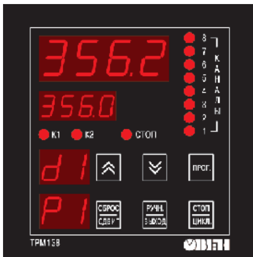
Рисунок 4.5 – Зовнішній вигляд кнопочкої панелі керування TRM138
