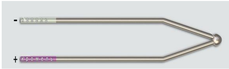
Рисунок 4.7. – Зовнішній вигляд термопар хромель - копель
