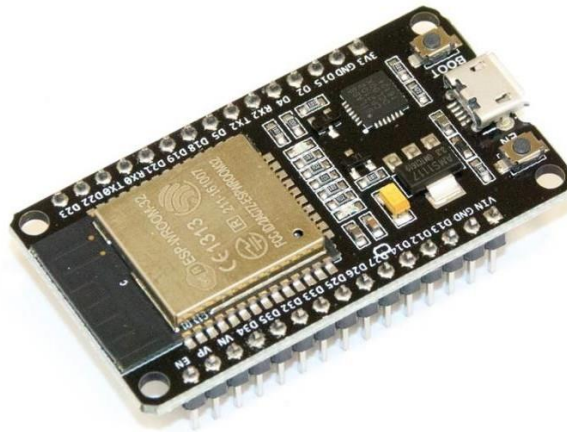
Рисунок 4.2 – Зовнішній вигляд мікроконтролера ESP32 [38]
