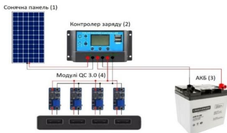
Рис.1.Спрощена схема автономної електростанції
