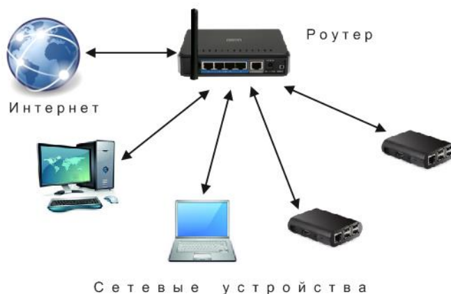
Рисунок 1.11 - З'єднання за допомогою маршрутизатора
