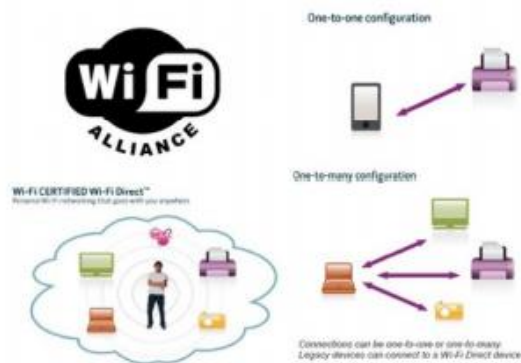
Рисунок 1.7 – Типи з'єднань Wi-Fi Direct
