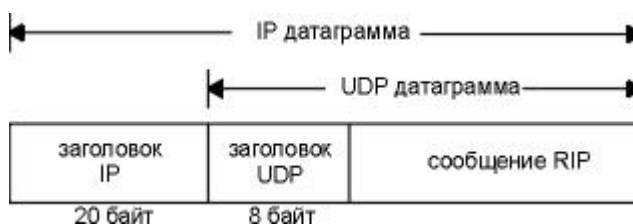
Рисунок 2.1 - Інкапсуляція RIP повідомлення в UDP датаграму
