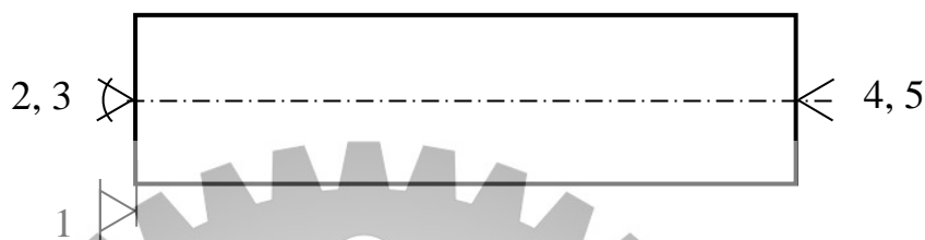
Рисунок 6.4 – Базування заготовки на токарних і шліфувальних операціях
