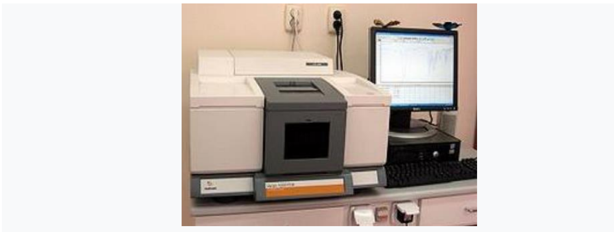
Рис. 2.4. Загальний вигляд сучасного приладу для ІЧ-спектроскопії [17]
