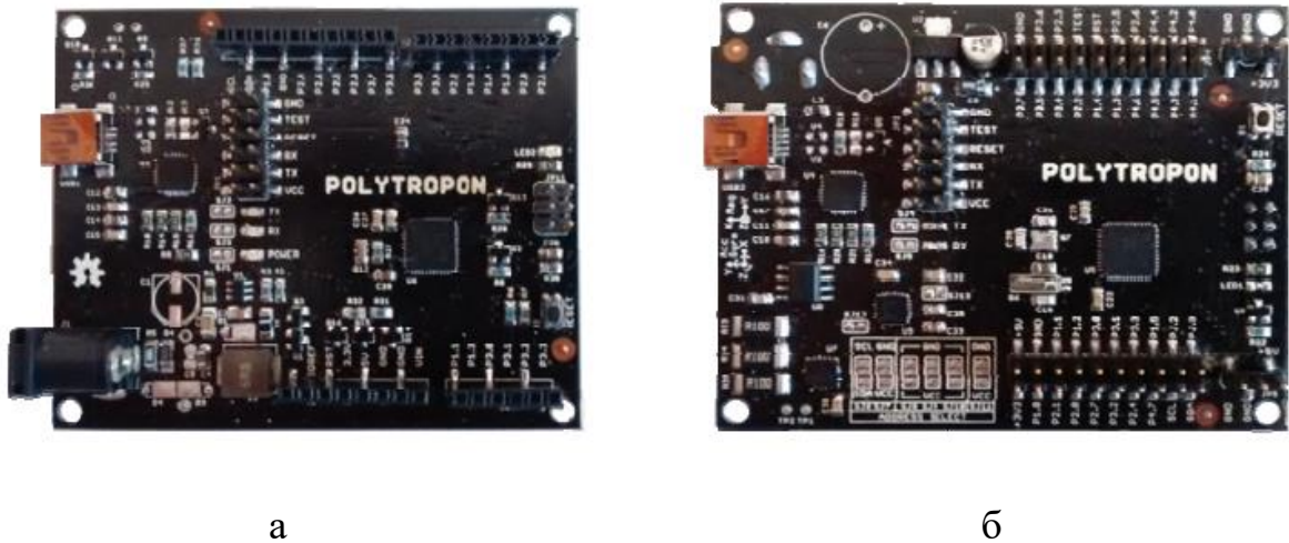
Рис. 3.4. Зовнішній вигляд двох типів плат платформи Polytropol сумісна з платами Arduino (а), сумісна з платами Launchpad (б) [33]
