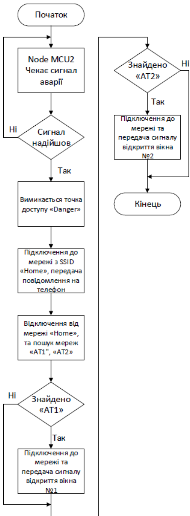
Рисунок 12 – Алгоритм функціонування блоку «Центральний блок передачі інформації»
