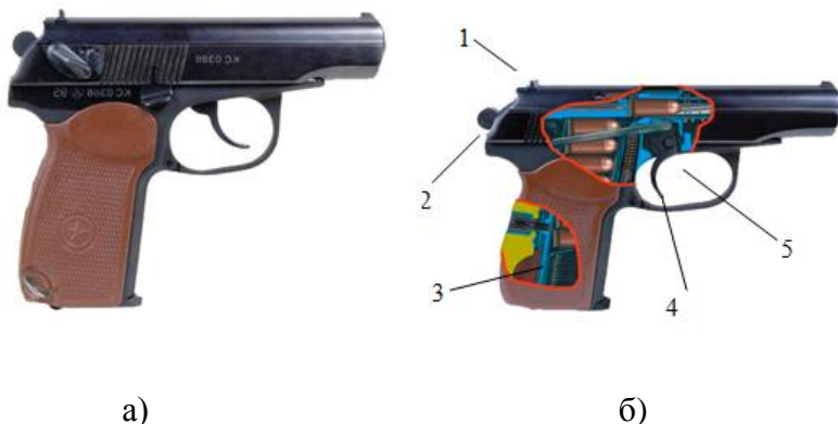
Рисунок 2.10 – Дев’ятиміліметровий пістолет Макарова: а) загальний вигляд; б) положення частин і механізмів пістолета перед пострілом у момент спускання курка з бойового взводу: 1 – затвор; 2 – курок; 3 – гвинт; 4 – спускова тяга; 5 – спусковий гачок
