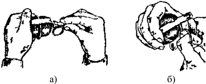
Рисунок 4.8 – Підготовка уламкової гранати РГД-5: а) угвинчування запалу; б) висмикнування чеки
