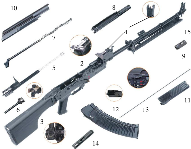
Рисунок 2.5 – Основні частини й механізми кулемета РКК-74М: 1 – ствол; 2 – ствольна коробка; 3 – приклад; 4 – прицільний пристрій; 5 – ударно-спусковий механізм; 6 – затвор; 7 – зворотний механізм; 8 – газова трубка зі ствольною накладкою; 9 – вогнегасник; 10 – кришка ствольної коробки; 11 – цівка; 12 – магазин; 13 – шомпол; 14 – пенал; 15 – сошка
