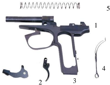
Рисунок 2.12 – Рамка зі стволом і спусковою тягою: 1 – загальний вигляд рамки; 2 – затворна затримка; 3 – спусковий гачок; 4 – бойова пружина; 5 – зворотна пружина
