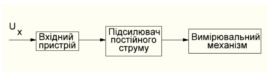
Рис. 1.1. Схема побудови електронного вольтметра постійного струму[3]
